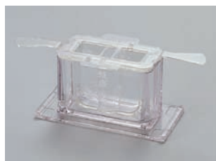
Copo de amostra pequeno (10ml) Usado para medir amostras de volume pequeno
