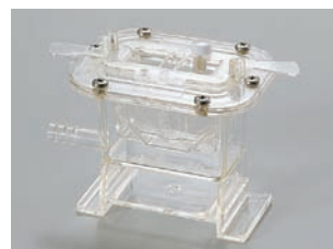
Camisa de água Usada para manter a temperatura da amostra constante, ou para alterar a temperatura. Também é necessário um tanque de água de temperatura constante.
